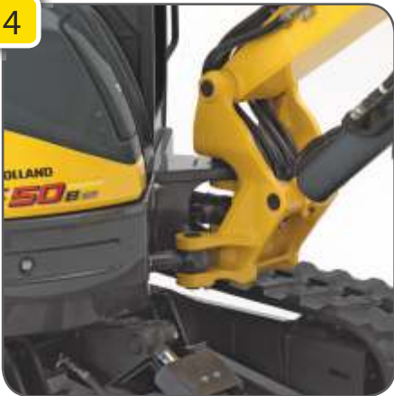
Güçlü bom dönüş mesneti + açıkta kalmayan hortumlar = uzun ömür
