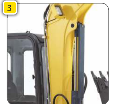
Bom silindiri, tüm çalışma koşullarında korunur.
