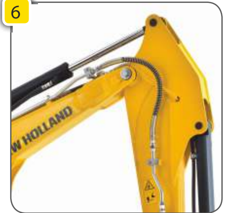
Kuvvetlendirilmiş bom/kol bağlantısı
