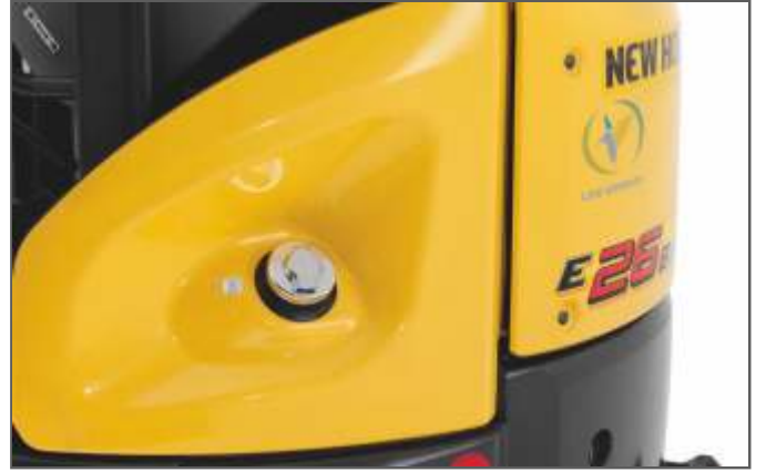
Yakıt tankı, zemin seviyesinden kolaylıkla doldurulabilir.
