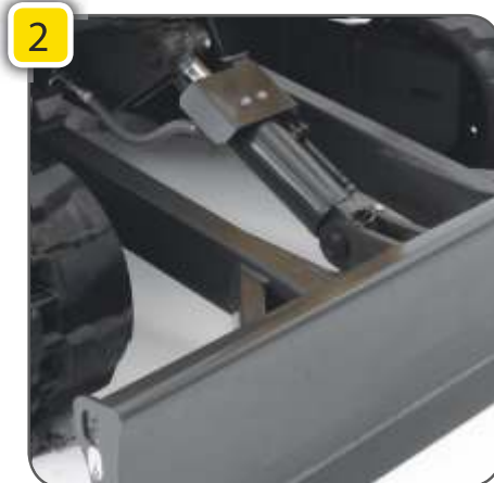
Korumalı hortum bağlantısı = uzun ömür
