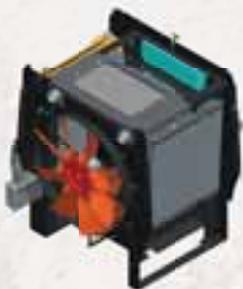
На большинстве колесных погрузчиков радиаторы располагаются один за другим. В компании New Holland мы сконструировали их в виде коробки. Выигрышем является лучшее охлаждение в любых, самых суровых условиях. Кроме того, благодаря программируемому реверсивному вентилятору, входящему в стандартную комплектацию, чистка радиаторов уходит в прошлое.
