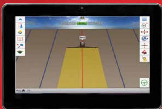
**ÉCRAN XCN 2050.** Pour la première fois, un système de commande Multi-Touch est intégré, permettant une utilisation facile, du bout des doigts. Avec le système d'exploitation Android, il est possible d'installer des logiciels supplémentaires, qui étendront les capacités du moniteur à d'autres applications agricoles avec des bandes lumineuses, les données météorologiques et les précipitations, et même des informations opérationnelles spécifiques à l'emplacement.
