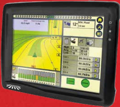
**FM-1000.** Cette console haut de gamme en termes de performance et de fiabilité, embarque une technologie à la pointe sur le secteur et deux récepteurs intégrés pour les signaux GPS et GLONASS. La console assure une précision de 20 à 2,5 cm d'un passage à l'autre, reproductible d'une année sur l'autre. Elle intègre également tout ce dont vous avez besoin en termes de systèmes de gestion de véhicules, de guidage et de cartographie.
