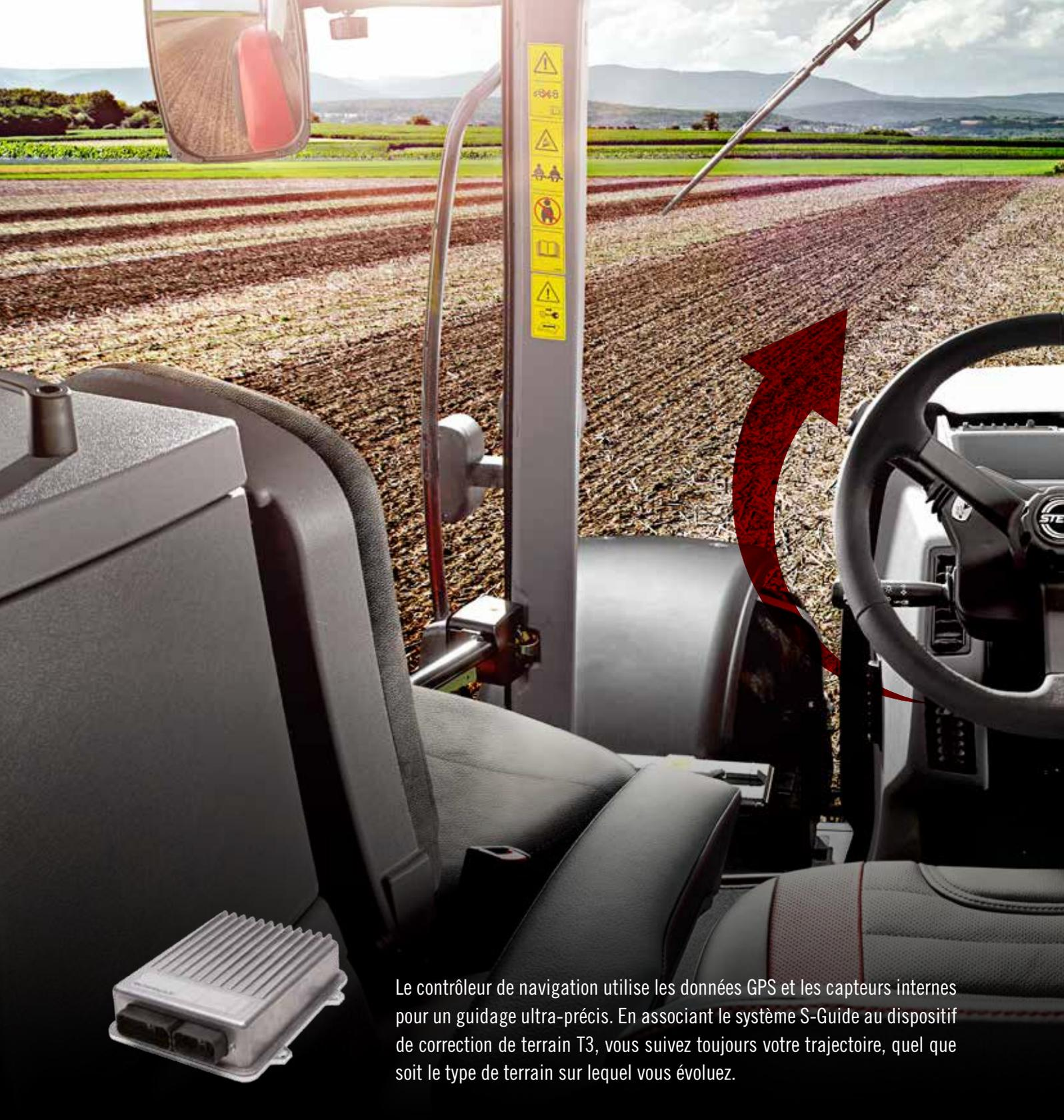
Le contrôleur de navigation utilise les données GPS et les capteurs internes pour un guidage ultra-précis. En associant le système S-Guide au dispositif de correction de terrain T3, vous suivez toujours votre trajectoire, quel que soit le type de terrain sur lequel vous évoluez.
