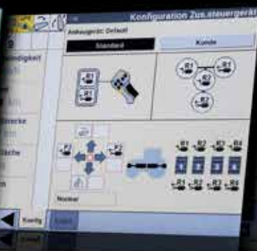
Przyporządkowywanie przycisków do obsługi zaworów hydrauliki zewnętrznej
