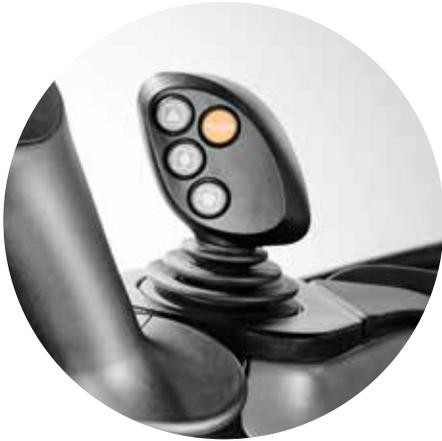
**Joystick caricatore frontale** Con tre pulsanti configurabili, Powershuttle e controllo della velocità.
