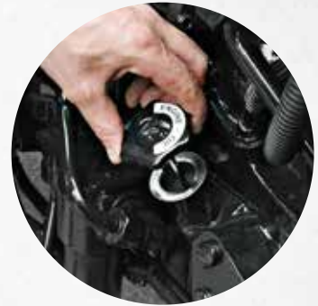
Contrôle du niveau d'huile et appoint en huile sans soulever le capot moteur.
