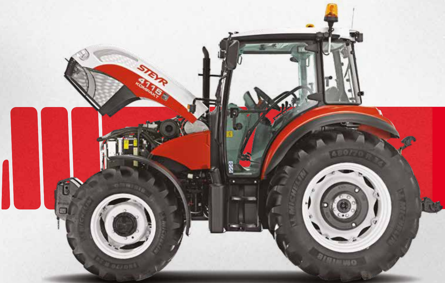
Grâce au nettoyage continu par filtre Piclon, l'entretien du filtre ne doit être effectué que lorsque le témoin correspondant s'allume.
