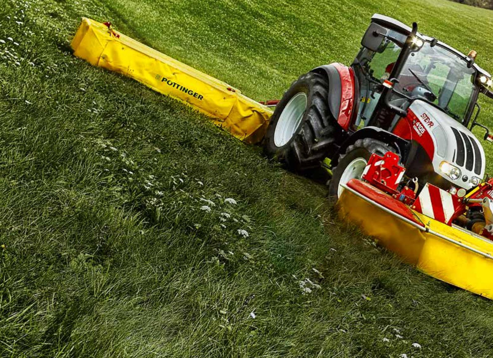
**STANDARD-FRONTMÄHWERK.** Das gesamte Gewicht des Frontmähwerts liegt auf dessen Gleitplatten oder den Rückspannfedern. Der unterschiedlich hohe Druck auf den Boden vermindert die Gras- und Silagequalität und ist wenig bodenschonend.
