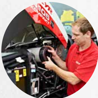
Continue reiniging via een cyclon-filter zorgt ervoor dat het filter alleen hoeft te worden onderhouden wanneer het betreffende waarschuwingslampje aan gaat.
