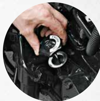
Controle van het oliepeil en bijvullen zonder omhoog tillen van de motorkap.
