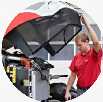
Le capot moteur monobloc à vérins à gaz peut être soulevé, même avec un équipement attelé à l'avant.
