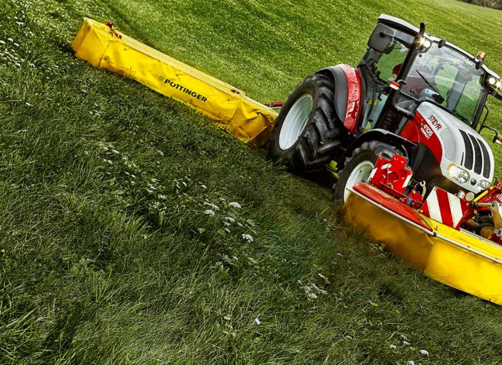
**RELEVAGE AVANT STANDARD.** Le poids de la barre de coupe avant repose entièrement sur ses patins ou ses ressorts de rappel. Une pression variable exercée sur le sol réduit la qualité de l'herbe et de l'ensilage et épargne peu le sol.
