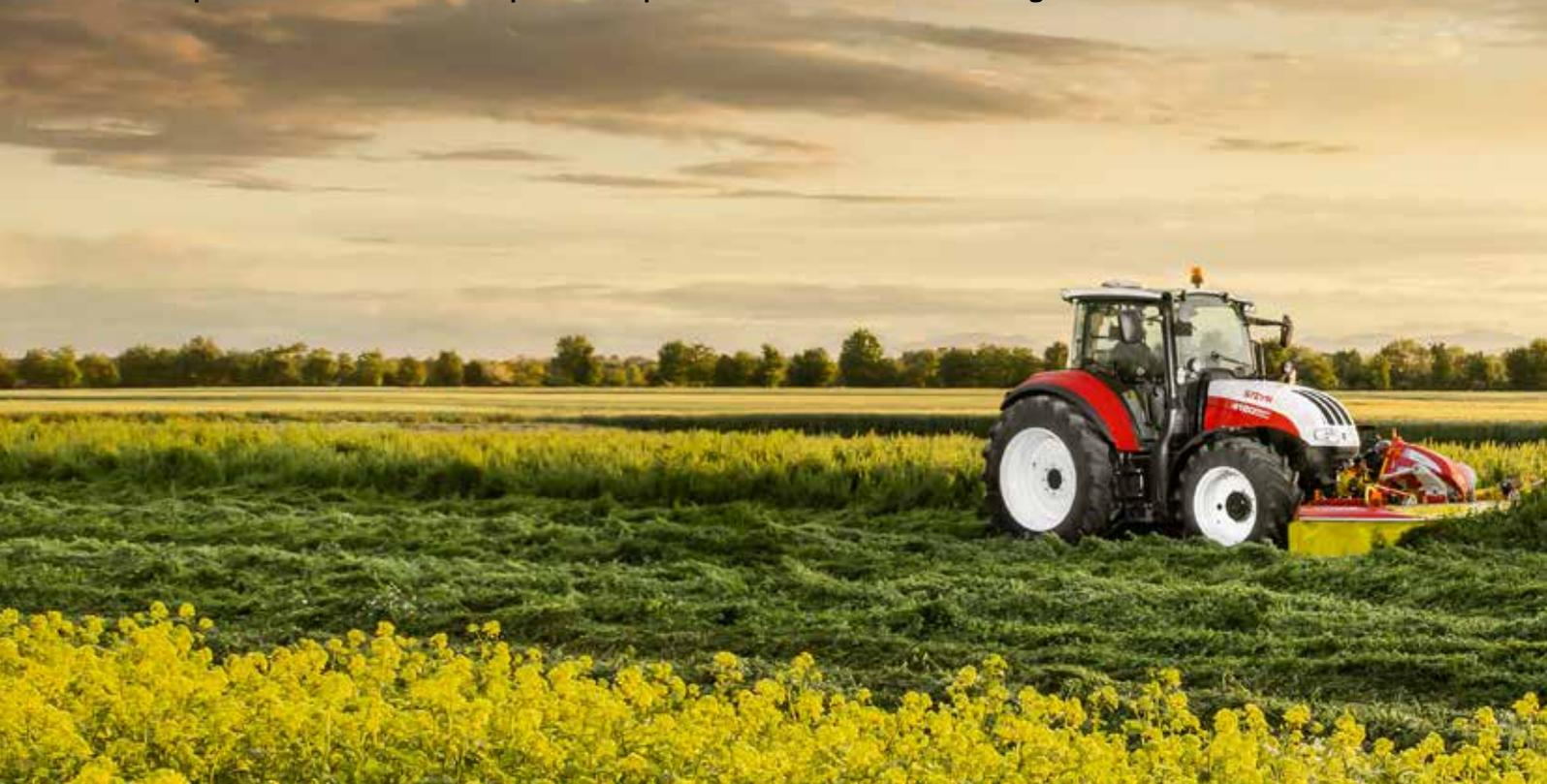
**SOLLEVATORE ANTERIORE STANDARD.** Il peso totale della barra falciante anteriore grava sulle relative piastre di scorrimento. La pressione elevata sul suolo abbassa la qualità dell'erba e dell'insilato ed è poco rispettosa del suolo.
