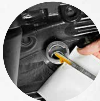
Kontrola poziomu oleju i uzupełnianie bez konieczności podnoszenia maski silnika.
