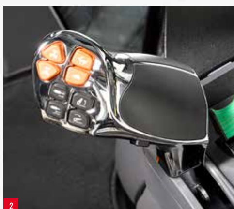
1 Klasyczna dźwignia przekładni w ciągniku Profi Profi Classic
