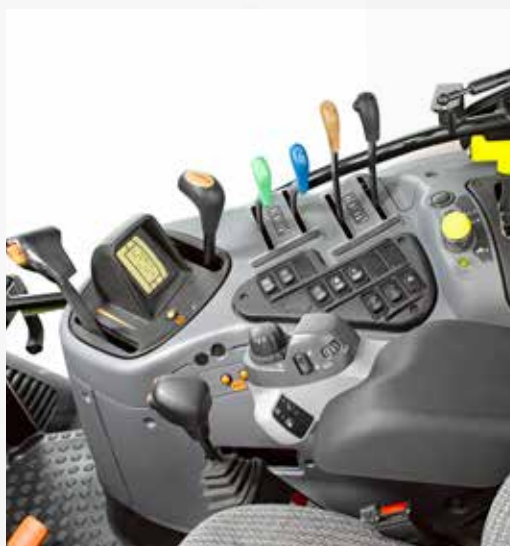
Profi Classic wyposażony w mechaniczne zawory hydrauliczne i elektroniczną regulację tylnego układu zawieszenia (EDC).
