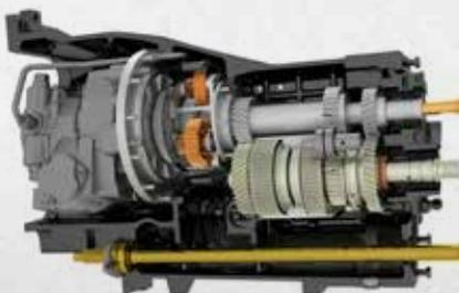
Trasmissione a variazione continua da 0 a 50 km/h
