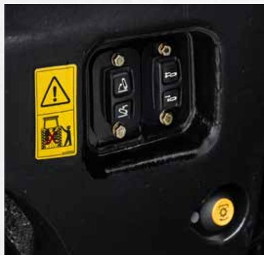
Leicht erreichbar: Die Außenbetätigung für Fronthubwerk, Frontzapfwelle und Steuergerät vorne.
