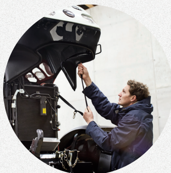
El capó de una sola sección con amortiguadores de gas puede subirse a dos posiciones (45°/90°), incluso con un implemento delantero.
