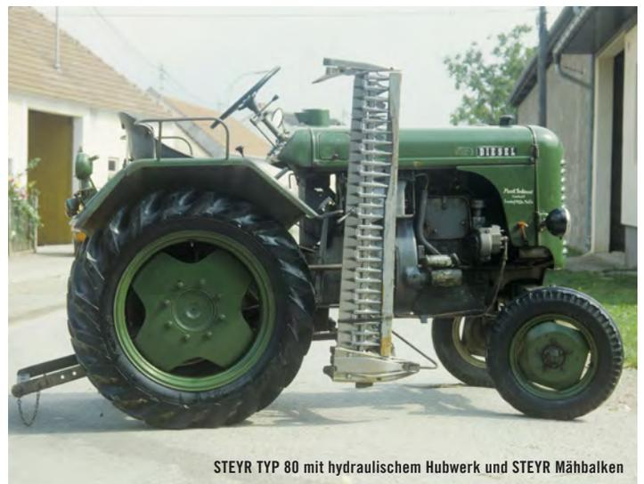
STEYR TYP 80 mit hydraulischem Hubwerk und STEYR Mähbalken
